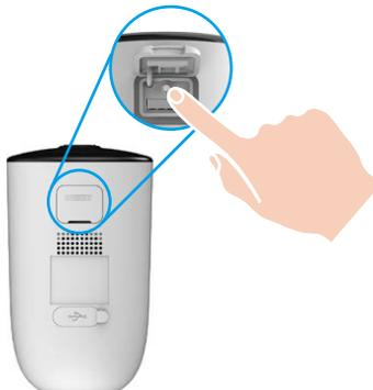
Se a câmara estiver sem bateria, ligue-a à tomada elétrica com o adaptador de corrente para proceder ao seu carregamento (5 V 2 A).
