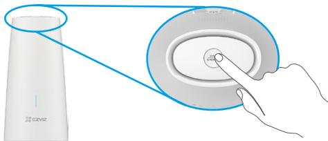
2. Posicione a câmara a 30-100 cm da estação de base. Mantenha premido o botão de SINCRONIZAR na câmara durante 4 segundos. O indicador LED piscará rapidamente a azul.
